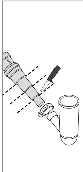
排水管也可以連接到水槽底部排水孔接頭。排水孔接頭的內徑至少要有 14 公釐。
