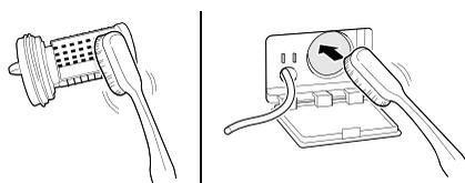
6 清潔排水泵濾網後，請謹慎小心地重新插入濾網，並順時針擰回排水蓋，以避免滑牙和漏水。
