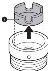
3 將接頭推入水龍頭末端，利用橡膠密封圈達到不漏水的狀態。緊固四個固定螺絲。
