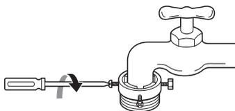
4 向上垂直推入進水管 ❸，使水管內的橡膠密封圈能夠完全貼合水龍頭，向右侧鎖緊。
